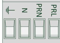
Für den Betrieb des econ sens3 ist eine Versorgungsspannung von 100..240 VAC erforderlich. Abb. 6 zeigt den Anschluss des Versorgungs-Einganges an das Netz. Anschlussbeispiele für 1- und 3-Phasen-Netze finden Sie in Kap. 5.10!
