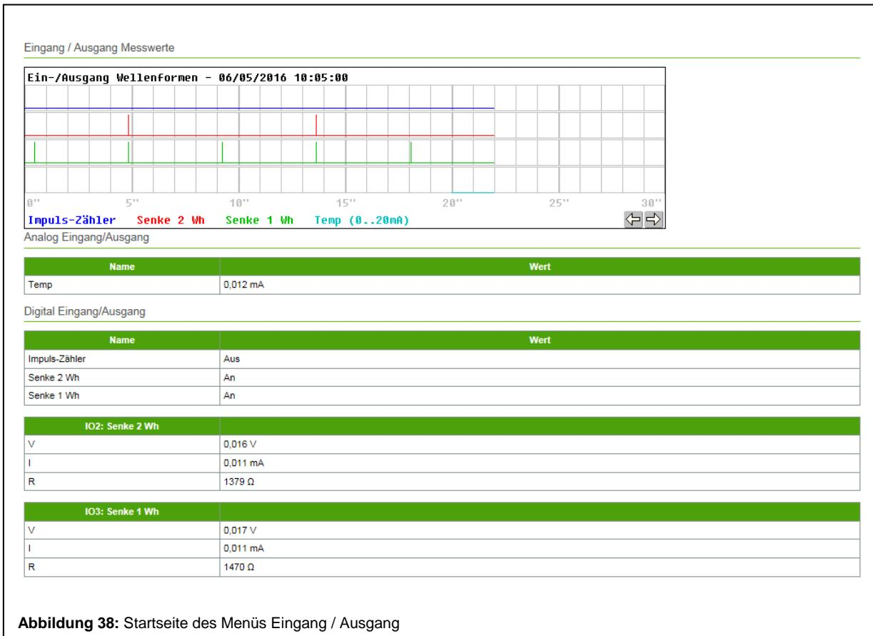
Das Menü Eingang / Ausgang erscheint bei konfigurierten Ein- und Ausgängen in der LOG-Version des econ sens3. **Diese ist per Options-Key freizuschalten (siehe Kapitel 8.10 Untermenü Optionen).** Im Menüfenster werden die anliegenden Werte / Impulse der digitalen oder analogen Ein- und Ausgänge angezeigt.
