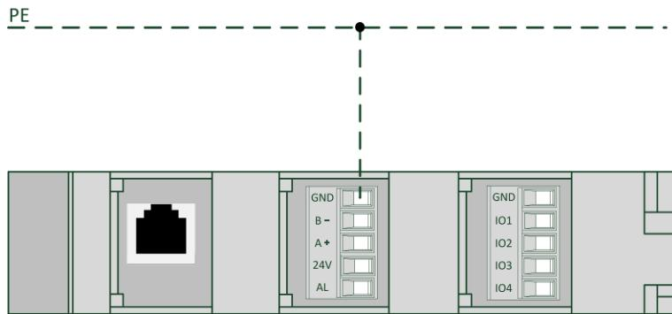
Abbildung 26: Funktionserdung am GND-Anschluss der Klemmstelle Modbus
