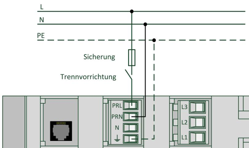
Abbildung 6: Anschluss Versorgungsspannung
