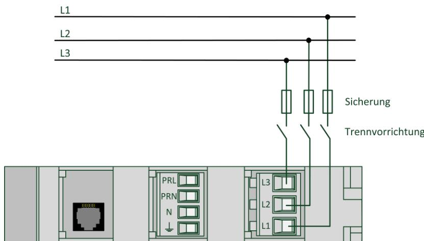
Abbildung 5: Anschluss Messspannung
