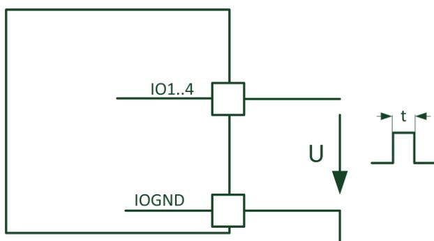
In der Konfiguration „Impulseingang“ können Spannungsimpulse von einem externen Gerät eingespeist werden. Der Eingang erkennt Impulse ab einer Spannung von 2 VDC und einer Mindest-Impulslänge von  $t = 20$  ms. Die Spannung am Impulseingang darf 30 VDC nicht überschreiten.
