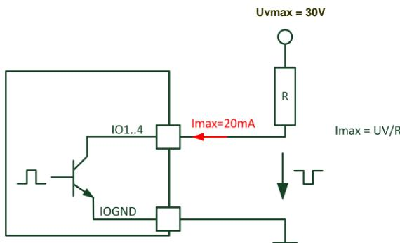
Für den Open-Kollektor-Betrieb ist eine externe Hilfsspannung von max. 30 VDC erforderlich. Der max. Strom durch den Transistor ist hardwareseitig auf 20 mA begrenzt. Der externe Widerstand ist so zu wählen, dass er diesen Strom durch den Transistor nicht überschreitet!
