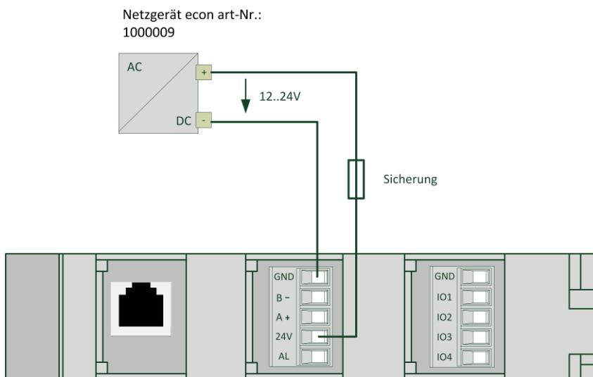
Abbildung 7: Alternative Versorgung des Gerätes mit 24 VDC
