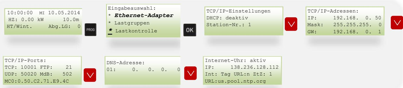
Wenn man nach unten navigiert, findet man die voreingestellte IP-Adresse. Durch die Tasten „←“ und „→“ kann man zu dem vorherigen/ nächsten Wert navigieren und mit den „+/-“ – Tasten kann der blinkende Wert angepasst werden. Bestätigen Sie mit der Taste „OK“.
